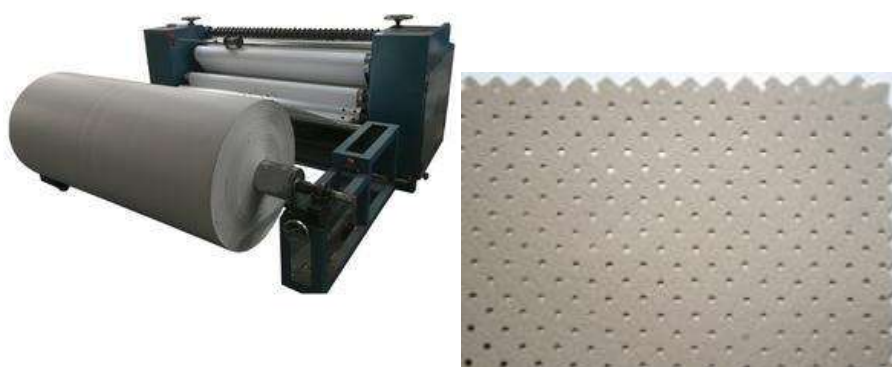
Сурет- 9. Перфорация аппараты 9.1 перфорация кезінде пайда болатын тесіктер
