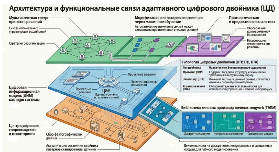
Рисунок 1 – Архитектура и функциональные связи адаптивного цифрового двойника
