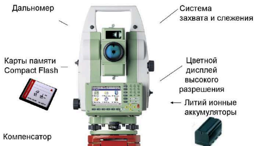
3-сурет. Қазіргі заманғы электрондық тахеометрдің құрылымы
