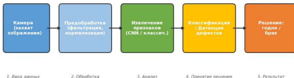
Рисунок 1 — Схема системы контроля качества на основе компьютерного зрения
