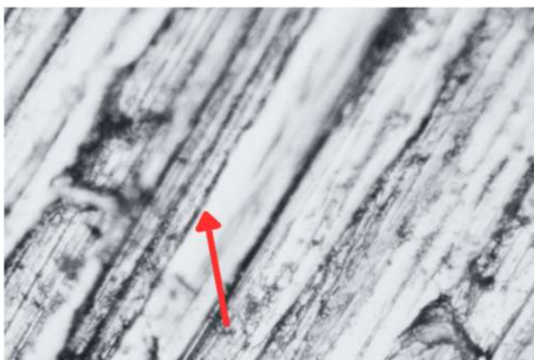
Рисунок 3 – Микрофотография поверхности шестерёнки, изготовленной методом селективного лазерного плавления
