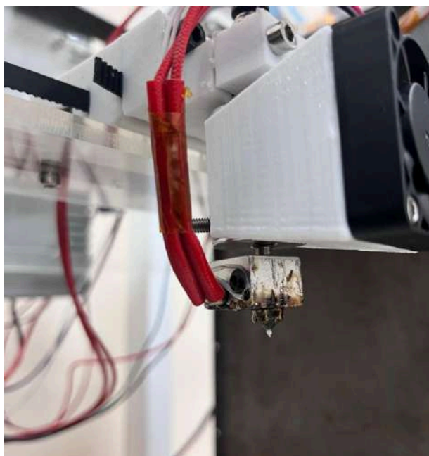
Рисунок 2 – Исполнительный узел лабораторной аддитивной установки
