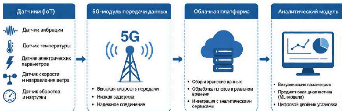
Рисунок 1 – Обобщенная архитектура цифровой системы мониторинга ветроэнергетической установки на основе 5G
