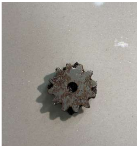
Рисунок 4 – Общий вид шестерёнки, изготовленной методом селективного лазерного плавления
